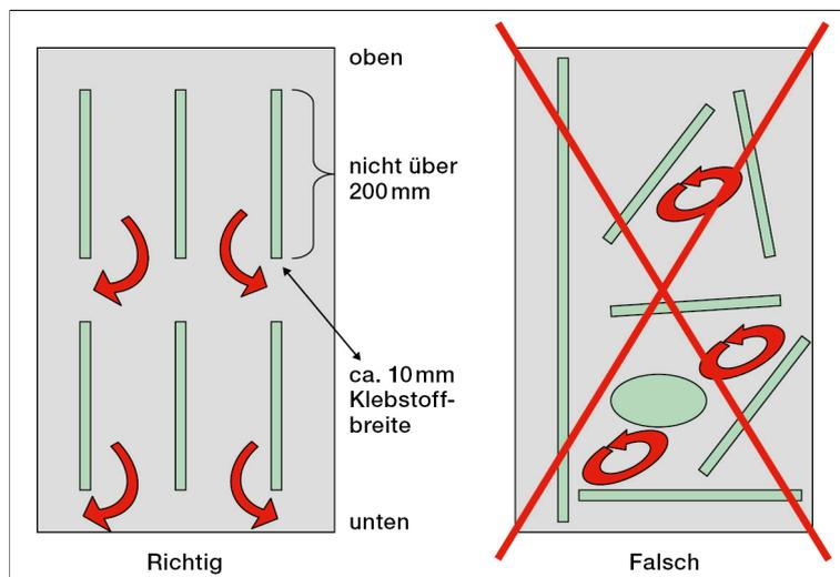
Bei der Klebung an Decken und bei der Klebung an Wände (wenn die Oberkante des Glases 4 m über der Bodenfläche liegt), muss das Glas / der Spiegel zusätzlich mechanisch z. B. durch Schrauben bzw. Einlegen in Rahmen gesichert werden.
