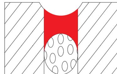
Durch die nach unten versetzte Fuge wird der Dichtstoff vor mechanischer Belastung geschützt
